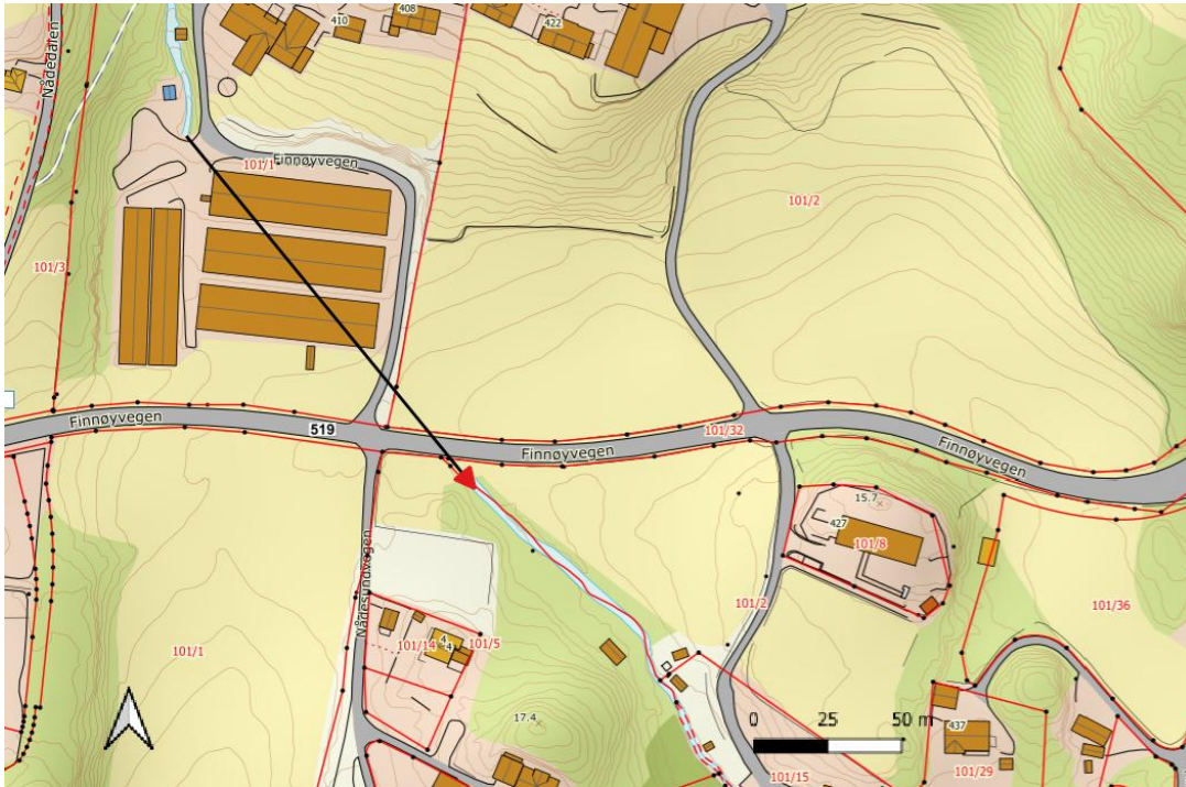
Figur 8: Eksisterende bekkelukking. Bekkelukkingen går under eiendom 101/1 og munner ut i åpen bekk nedstrøms på eiendom 101/2.
